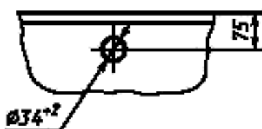
Рисунок 5 — Расположение и размеры отверстий в полочках умывальников для установки смесителей
